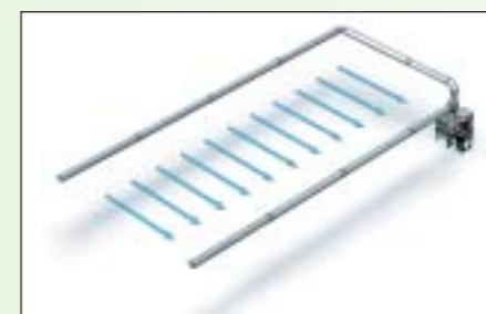
Een U-vormig zuigblaassysteem met 1 filterunit en ventilator.
