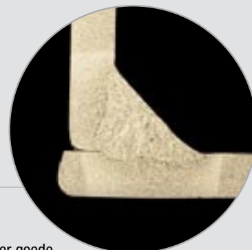
Ferromaxx® 7 MAG staande hoeklas in 3 mm staaldikte
