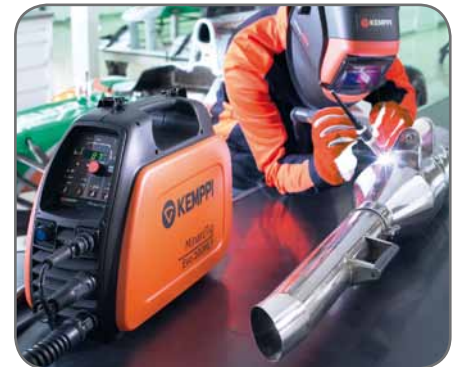
De MinarcTig Evo reeks is de ideale DC TIG-lasoplossing voor installatie-, reparatie- en onderhoudsapplicaties
